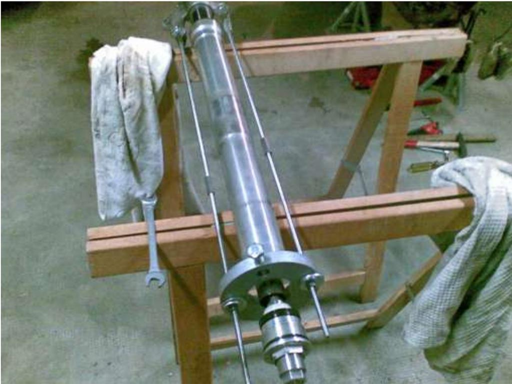
Con una spatola abbassare il parapolvere (pos. 2), con un cacciavite togliere il seiger (pos. 16) sotto il parapolvere per liberare il corteco, dare dei colpetti tirando lo stelo verso il punto di massima escursione per far uscire i cortechi e le boccole di guida(pos. 17 18 19 20)
