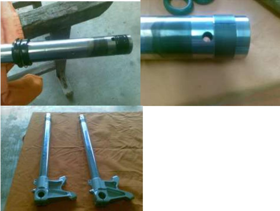
Prima di riavvitare il blocco superiore avvitare il registro a taglio di cacciavite sulla sommita forcella fina ad un ipotetico tutto chiuso, attenzione non ha piu un finecorsa lasciate chi il taglio cacciavite sia esterno al bordo superiore, ora avvitare a mano il blocco sulla asta interna quando e' in battuta( sempre a mano non forzare) serrare il controdado; quello e' il nuovo tutto chiuso.
