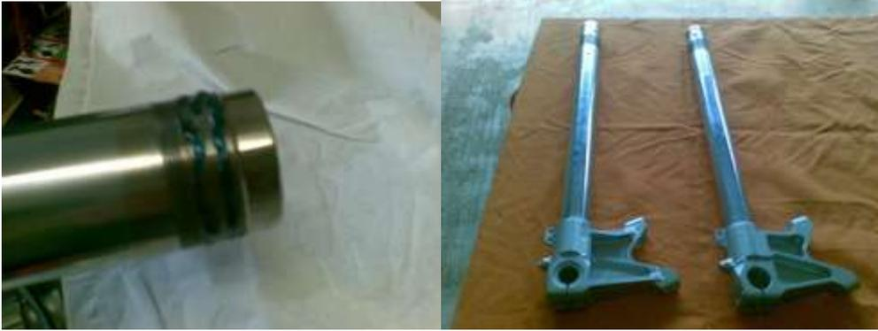
Inserire nel giusto ordine il parapolvere gli anelli paraolio le boccole, aiutarsi con un tampone di teflon(in foto il mio autocostruito) o di materiale morbido per mettere in sede gli anelli rimettere il seiger in posizione
